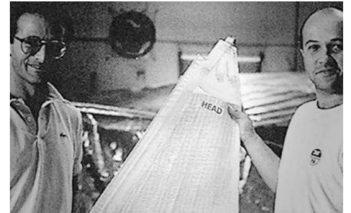
de Merit, le nouveau Maxi de Pierre Fehlmann. Une des voiles d'avant montre de sérieux signes de faiblesses aux coutures. «C'est en renforçant ce génois en voilerie que je me suis dit que si le tissu composite et la voile étaient formés simultanément en une seule pièce, avec les fils structurels continus, on éliminait entièrement le besoin de coutures, déclare Jean-Pierre Baudet. Pour cela un moule 3D serait nécessaire.»
